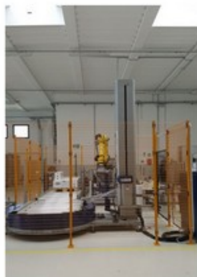
avvolgitore da linea con robot fully auto stretch wrapper with robot
