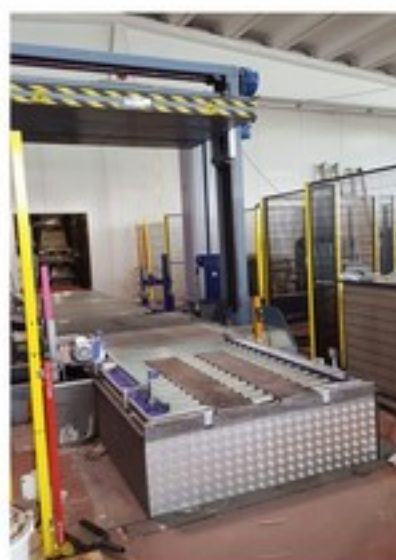
avvolgitore da linea con pressa reggiatrice fully auto stretch wrapper with strapping press
