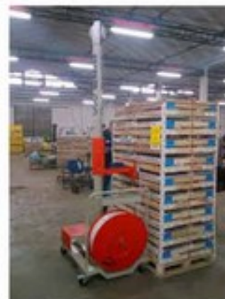
OMS 600 sistema orizzontale con tendireggia a batteria
