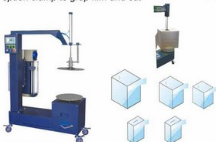
WM 800 B versione per avvolgimento scatole box wrapping version
